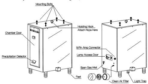
Figure 4-4. Nephelometer Exterior Diagram.
